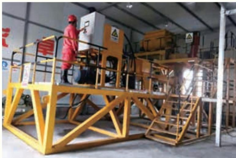
加压环管稳态输送装置
